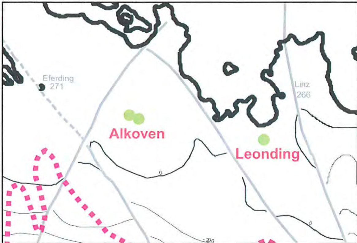
Abbildung 26: Detailansicht der Karte des Molasseuntergrundes (modifiziert). Auf der Karte sind zwei Störungen im Molasseuntergrund zu sehen, die O und W von Alkoven verlaufen.
